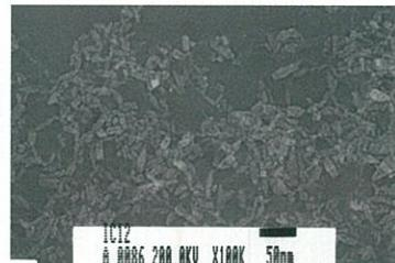
槍型形状の酸化チタンは被覆面積における表面積が大きく、光を受ける面や有機物との接触面が増えることで、光触媒効果をより高く発揮することができます。
