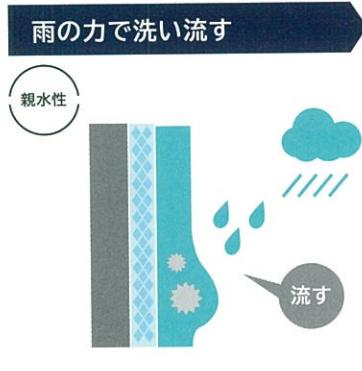
光触媒の分解力で、付いてしまった油汚れ（排気ガス、工場の排煙等）を分解し、汚れの付着力を弱めます。
